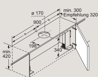
Bei Montage der 90 cm Flachschirmhaube in einen 90 cm breiten Oberschrank ist ein Montage-Set erforderlich. Die beiden Montagewinkel werden links und rechts im Möbel verschraubt. Montage nach Schablone.
