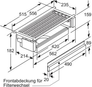
Frontabdeckung für Filterwechsel
