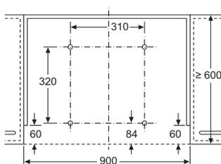
Montage Flachschrühhaube mit Absenkrahmen
