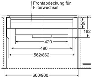
Frontabdeckung für Filterwechsel
