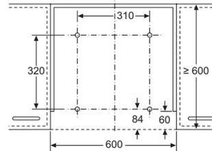
Montage Flachschriftmaube mit Absenkrahmen
