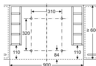
Montage Flachschrühhaube mit Absenkrahmen
