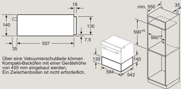
Über eine Vakuumschublade können Kompakt-Backöfen mit einer Gerätehöhe von 455 mm eingebaut werden. Ein Zwischenboden ist nicht erforderlich.
