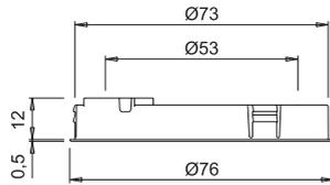
Die Leuchte HOLL D-MOTION ist ein ringförmige Leuchte zur Unterstützung hochwertiger Oberflächen in Möbeln. Je nach Wunsch kann die Abdeckkappe verwendet werden oder entfallen. Bei den Leuchten mit Schalter wird die Abdeckkappe zum Schalter bzw. Dimmer umfunktioniert. Erhältlich in schwarz matt oder edelstahlfärbig.
