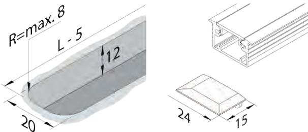
**Einfräsprofil 24 x 12 mm**
