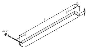
TOP Stick Langfeldleuchten sind hocheffiziente Langfeldleuchten zum Aufbau. Die Leuchten können vor Ort auf die benötigte Längen gekürzt werden. LED Band ist lose im Profil, kürzbar alle 25 mm
