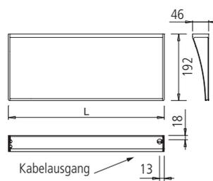
Leuchtrehal mit extra hellem, nur 4mm dicken Glas zwei LED-Strips, eine zur diffusen Beleuchtung des Glasbodens und eine für die asymmetrische Unterbeleuchtung
