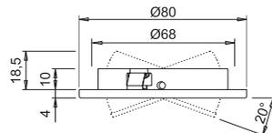
Schwenkbarer Einbauspot für akzentuierte Beleuchtung mit verstellbarer Lichtfarbe. Die Auswahl der Lichtfarbe kann statisch oder dynamisch verändert werden.
