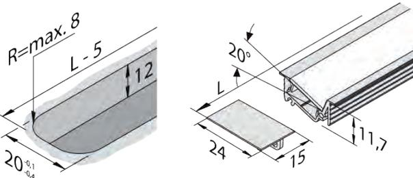
**Einfräsprofil Asmetrisch innenliegend**
