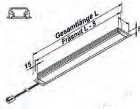
IN Stick Langfeldleuchten sind hocheffiziente Langfeldleuchten zum Einbau. Die Leuchten können vor Ort auf die benötigte Längen gekürzt werden. LED Band ist lose im Profil, kürzbar alle 50 mm
