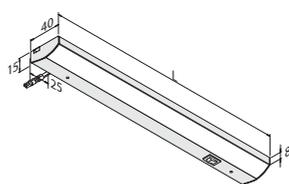
Unterbauleuchten für homogene Arbeitsplatzbeleuchtung mit integriertem Konverter und Schalter, eignet sich für perfekte Lichtbänder bis zu einer Länge von 13 m.
