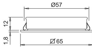
Quadratischer Einbauspot mit verstellbarer Lichtfarbe
