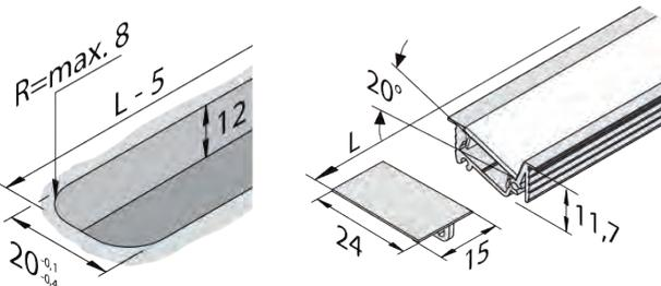
**Einfräsprofil Asmetrisch innenliegend**
