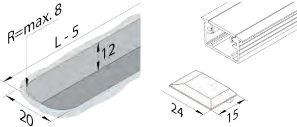
**Einfräsprofil 24 x 12 mm**
