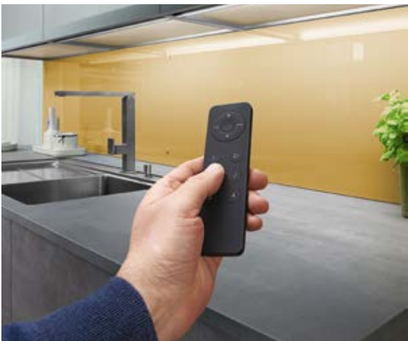
Das neue 24 V LED-Lichtsystem kann mittels Fernsteuerung oder Smartphone-App hinsichtlich der Leuchtintensität, je nach Situation, verändert werden.
