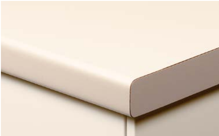
Arbeitsplatte 40 mm, weiß, panna, Schichtstoff doppeltgerundet, Radius 6 mm
